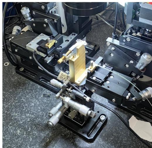
(3) 芯片夹具、垂直/水平光纤夹具 (可定制)
